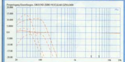
Der Bass-EQ ermöglicht es, die Mittenfrequenz des Bass-Boost zwischen 30 Hz und 50 Hz zu verschieben.
